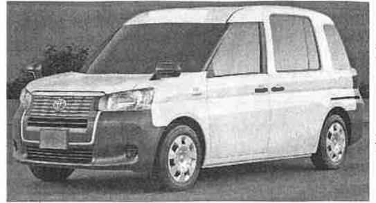
トヨタ自動車（本社・豊田市、豊田章男社長）は9月末をメドに、軽貨物クシシーのバン仕様車をリリースする。後部座席を外して荷室空間に転用し、木質ボードでフラットな床面を確保することで200キログラムの積載量を實現。タクシーが備える耐久性と安全性、乗り心地はそのままにLPGカ
